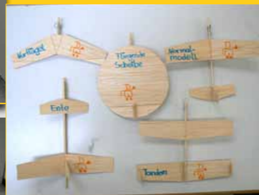
Diese fünf verschiedenen Modelle entstehen aus einem Balsabrett und repräsentieren die unterschiedlichen Flugzeugtypen mit all ihren Eigenheiten – vom Nurflügel bis zur Ente. 1958 waren Balsabrettchen noch 75 mm breit und 900 mm lang. Heute sind sie 100 mm breit und 1000 mm lang, sodass genügend Holz übrig war, aus dem so manche Eigenkonstruktion entstanden ist
